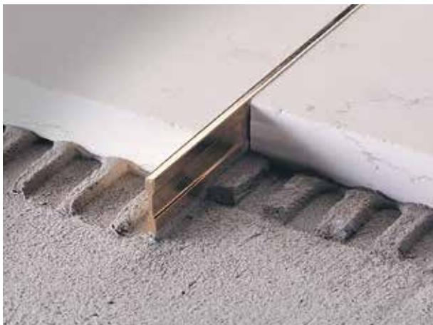
Linetec PT sono profili di frazionamento disponibili in diverse altezze per adattarsi ai vari spessori dei pavimenti. La parte in vista del profilo risulta essere di 2,5 mm. Facilmente deformabili, permettono di ottenere disegni decorativi che li rendono particolarmente indicati per la posa della palladiana e delle pavimentazioni in agglomerati cementizi o a base di resine. I profili sono levigabili in opera.
